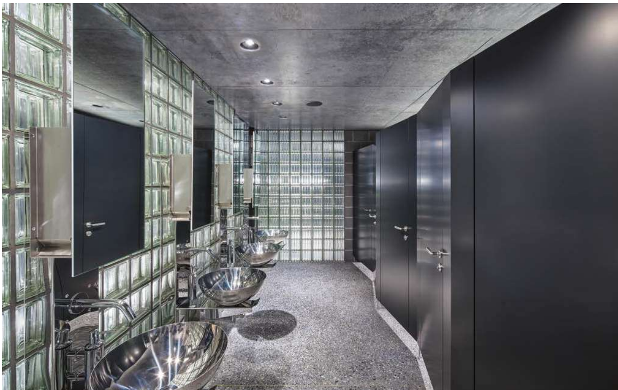
Die Gestaltung der Sanitärräume im Erdgeschoss der Kuben folgt dem industriellen Materialkanon. Eigens angefertigte glänzende Waschplätze werfen Lichtreflexe in den Raum. Als Echo der gefalteten Betonfassade sind auch die innenliegenden Flächen abschnittsweise geknickt.
